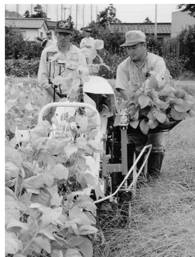
ヤンマー社員に教わりながら「HE1」の試運転をする丸山勉さん。抜き取っただだちゃ豆は、サイドのバケットに集束される
